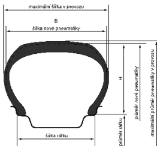
Obrázek 54: Hlavní rozměry pneumatik (Zdroj: Pneumatico)
