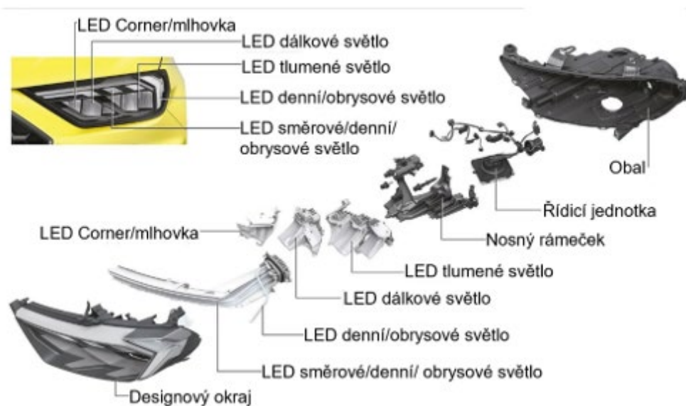
Obrázek 68: Sestava LED Matrix reflektorů (Zdroj: Net Car Show)
