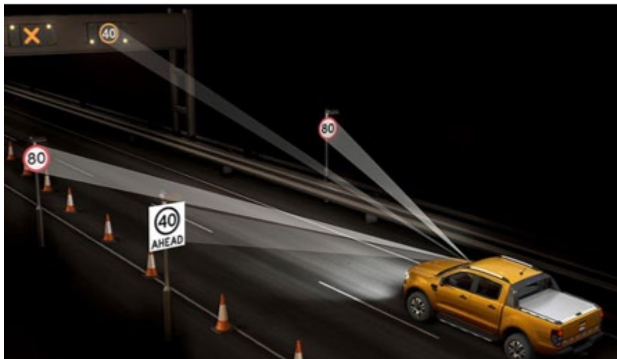
Obrázek 73: Asistent pro identifikaci dopravních značek (Zdroj: A62 a SDN)
