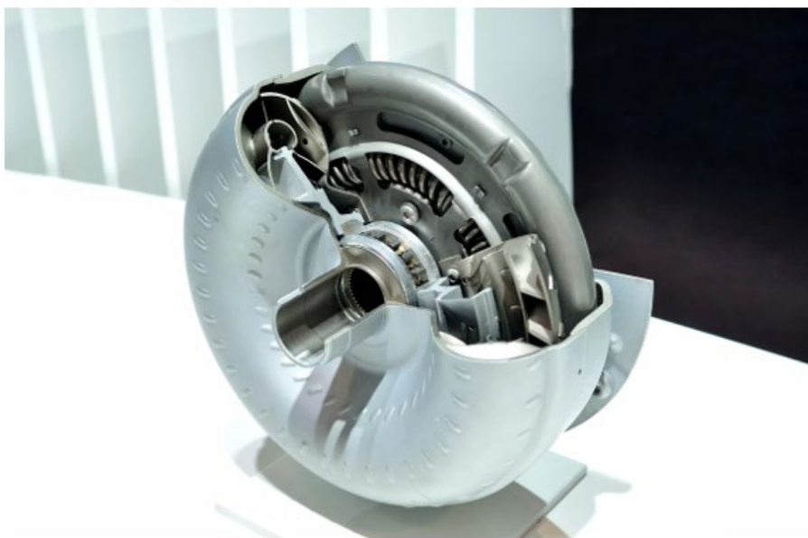
Obrázek 29: Hydrodynamický měnič (Zdroj: Archiv autorů)
