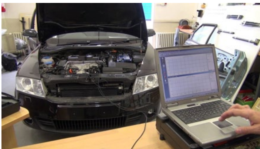
Obrázek 79: Orientační měření komprese (Zdroj: Ytimg)
