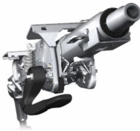
Obrázek 37: Bezpečnostní sloupek řízení (Zdroj: Archiv autorů)
