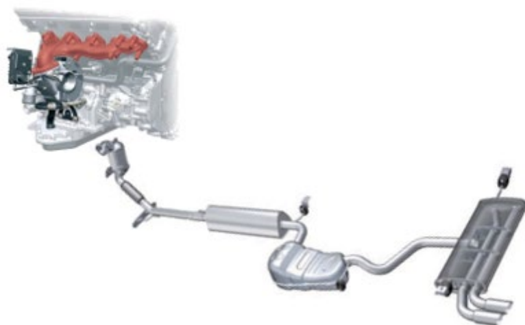
Obrázek 19: Uspořádání výfukového systému zážehového motoru (Zdroj: Archiv autorů)
