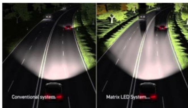
Obrázek 70: Porovnání viditelnosti Konvenčního a LED Matrix osvětlení (Zdroj: D62 a SDN)
