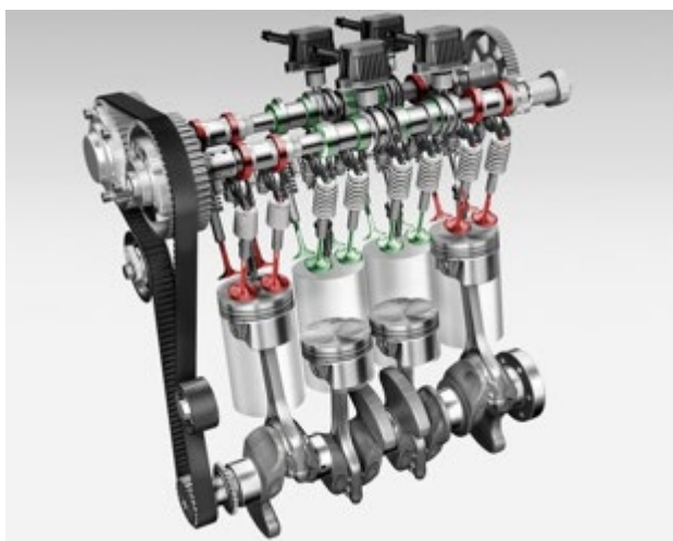
Obrázek 83: Uspořádání rozvodů u motoru s vypínáním válců (Zdroj: Auto.cz)
