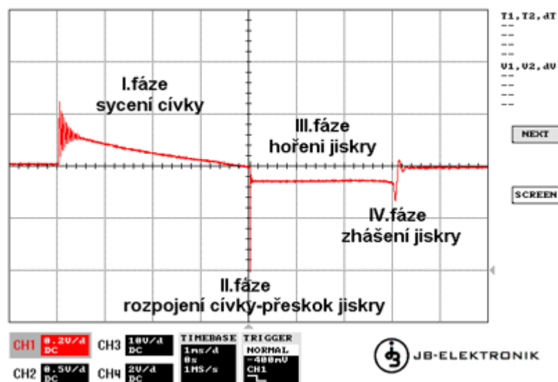
Obrázek 78: Záznam z kontroly zapalování (Zdroj: JB Elektronik)
