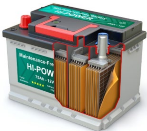
Obrázek 72: Konstrukce Pb akumulátoru (Zdroj: TZB INFO)
