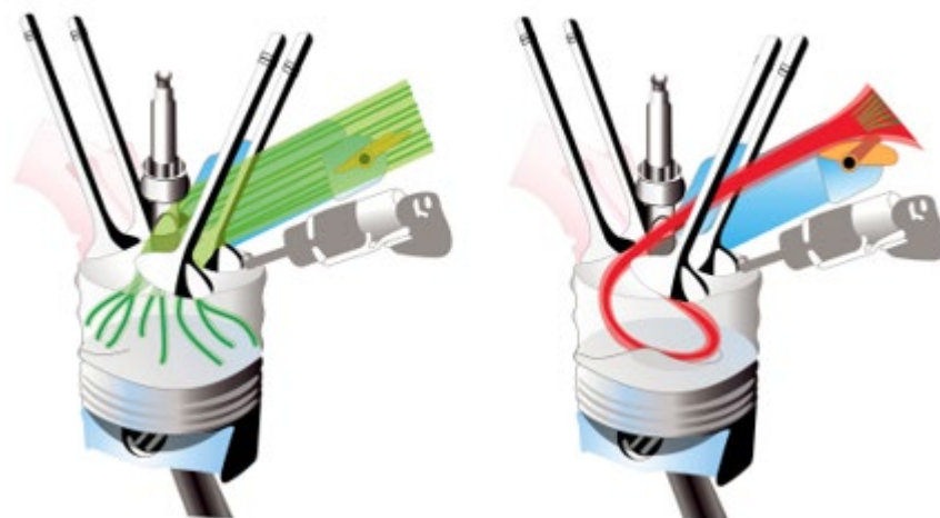
Obrázek 27: Homogenní a stratifikované spalování (Zdroj: Archiv autorů)
