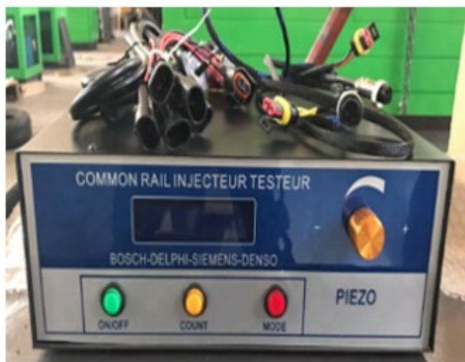
Obrázek 26: Diagnostika vstřikovacích ventilů CR včetně piezo ovládání (Zdroj: Archiv autorů)
