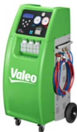
Obrázek 61: Plnicí stanice klimatizace (Zdroj: Protex)
