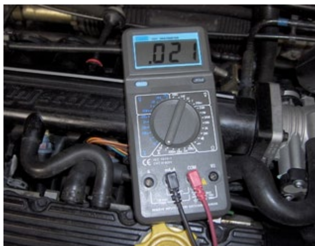
Obrázek 80: Odběr proudu vozidlem naprázdno (Zdroj: Land Rover fórum)
